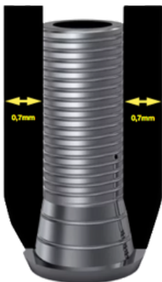
Espessura mínima em Zonas de Baixa Exigência Mecânica
